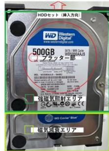
注意 2.5インチHDDは、HB（HYBRID複合）/磁気消去のみの場合もB面に2.5インチHDDアダプタを定位置にセットする。
