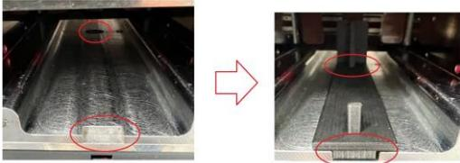
B面の物理破壊エリアにストッパーをセットする。
