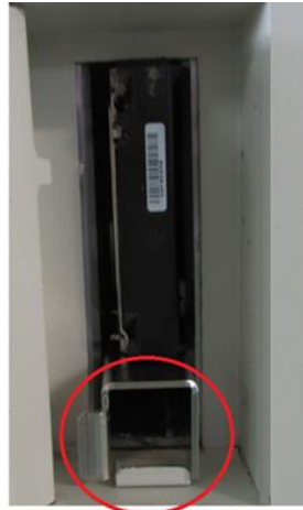
1~4TB HDD対応アダプタ(1~2箇所圧壊)
