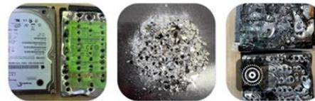
SSD/HDD 第二種可燃性金属 40°Cで引火の危険 保管管理が厳しく規定されています。
