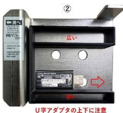
4) ①②に 2.5 インチ HDD セットする。4 カ所の貫通破壊が可能です。
