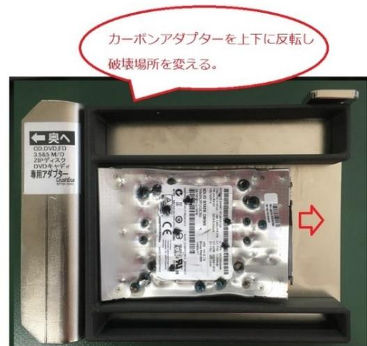
2) ①②に③のゴムアダプタを乗せる。薄い1.6~2.5インチ HDD の貫通破壊が可能です。
