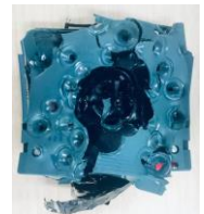
4回移動クラスター破壊 16カ所の孔とねじれ切断 (40秒)
